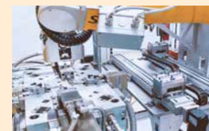
Der Stäubli TX2-60L ist Teil einer vollautomatisierten Maschine, die täglich 600.000 Impfstoffbehälter herstellt. Die Vials werden gehandhabt, bearbeitet und geprüft. Bild: Zahoransky
